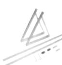
FKF 6-2  | 8 718 531 034 | 4 051 516 044 916 | Bastidor soporte básico adicional para montaje de captadores horizontales sobre cubierta plana.<br>- Permite regulación del ángulo de inclinación, entre 30° y 60°, con ajustes de 5 en 5 grados.<br>- Realizado en aluminio.<br>- Permite fijación sin anclajes, mediante el empleo del accesorio FKF 7.<br><b>- Necesario uno por cada captador de cada grupo, excepto el primero.</b> | <b>160</b>             |
