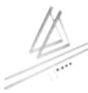
FKF 5-2  | 8 718 531 033 | 4 051 516 044 909 | Bastidor soporte básico para montaje de captadores horizontales sobre cubierta plana.<br>- Permite regulación del ángulo de inclinación, entre 30° y 60°, con ajustes de 5 en 5 grados.<br>- Realizado en aluminio.<br>- Permite fijación sin anclajes, mediante el empleo del accesorio FKF 7-2.<br><b>- Necesario uno por cada grupo de captadores.</b>                                | <b>175</b>             |
